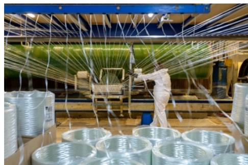
La résistance mécanique de la station, et notamment la tenue au flambage, est obtenue grâce à l'association d'un enroulement filamentaire orthogonal et Hélicoïdal.
