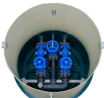
Le regard CRP est fabriqué en polyester renforcé de fibre de verre (PRV). Il est constitué d'un fond plat avec canal de récupération des eaux d'égouttures, d'une virole et d'un couvercle (en option). Il est équipé principalement d'une tuyauterie et de robinetterie.
